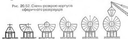
Рис. 20.53. Послідовність збирання резервуара методом послідовного нарощування при горизонтальній орієнтації блока
