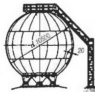
Рис. 20.51. Сферичний резервуар об'ємом 600 м 3
