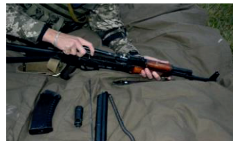
Іл. 19.8. Відокремлення затворної рами із затвором
