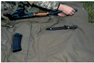
Іл. 19.5. Відокремлення дульного гальма-компенсатора
