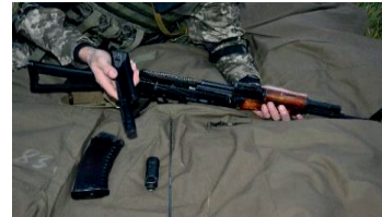
Іл. 19.6. Відокремлення кришки ствольної коробки
