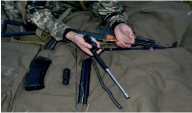
Іл. 19.9. Відокремлення затвора від затворної рами
