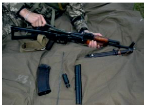
Іл. 19.7. Відокремлення зворотного механізму
