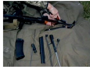
Іл. 19.10. Відокремлення газової трубки
