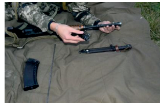
Іл. 19.5. Відокремлення дульного гальма-компенсатора
