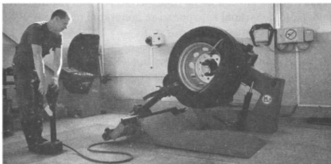
**Рис. 1.22. Шиномонтажне обладнання**
