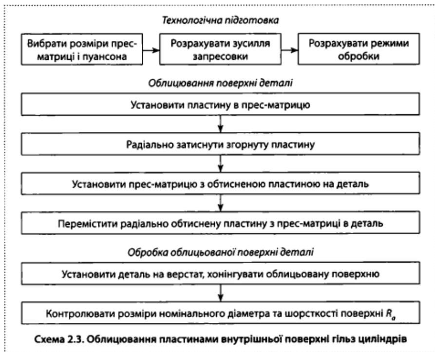
Підготовка гільз циліндрів під облицювання пластинами полягає в їх розточуванні під запресовування згорнутих пластин. Розточують гільзи циліндрів ельборовим різцем на алмазно-розточувальному верстаті у спеціальному пристосуванні (рис. 2.4).
