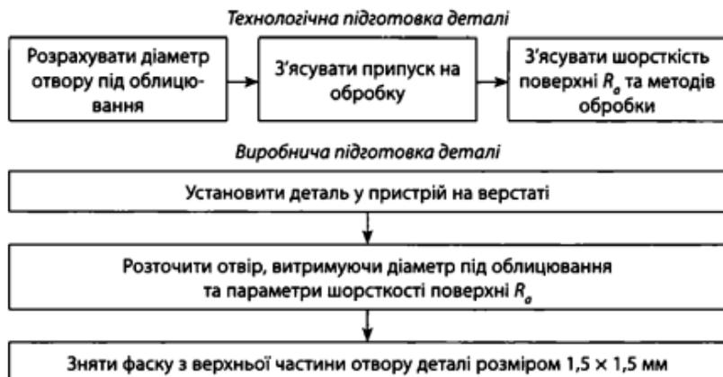
**Схема 2.1. Технологічний процес відновлення деталей пластуванням**
