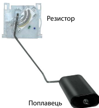
Мал. 4. Датчик рівня пального в автомобілі
